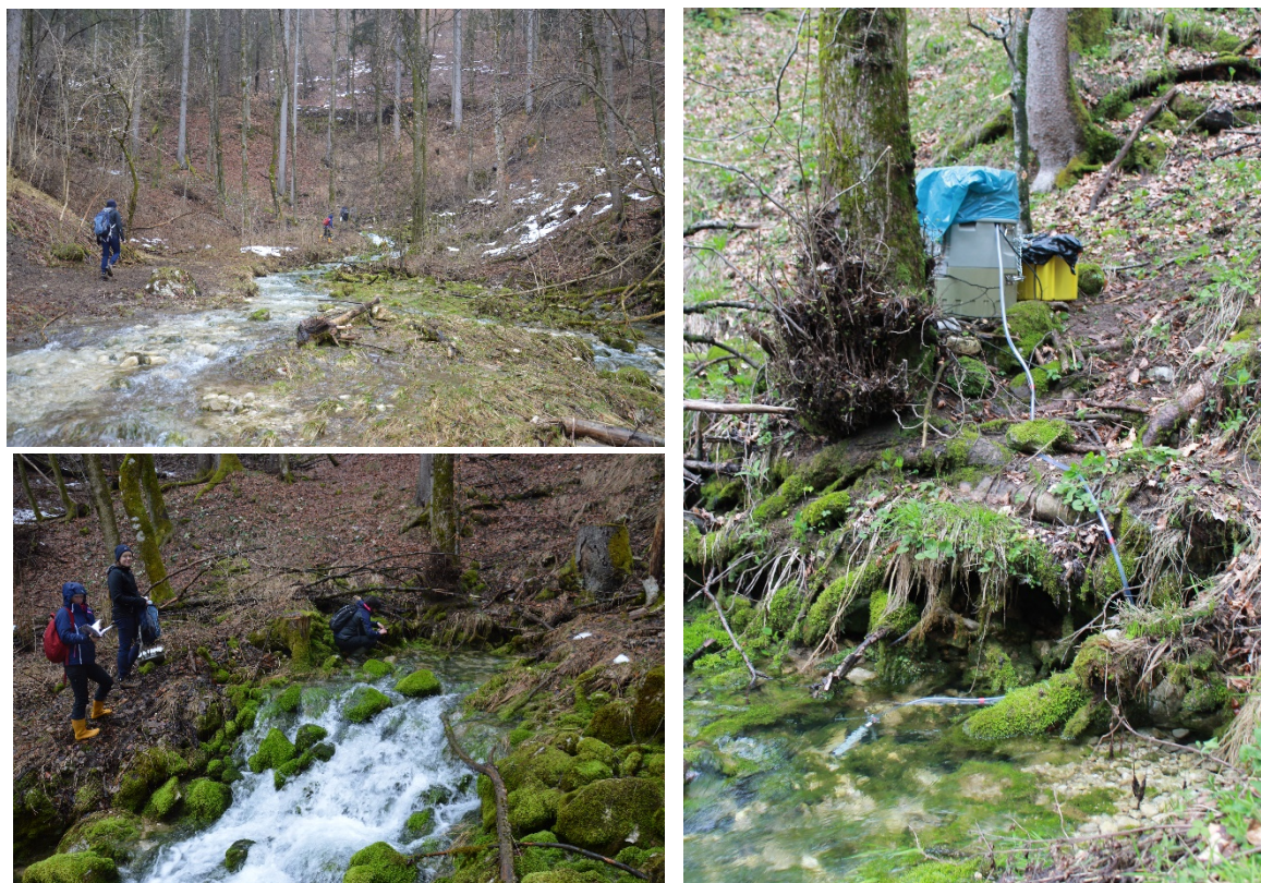
Slika 3.: Avtomatski vzorčevalnik ISCO 6712 na izviru Smešnik.
